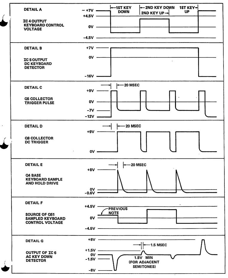
FIGURE 2-1 KEYBOARD TRIGGER VOLTAGE WAVEFORMS
