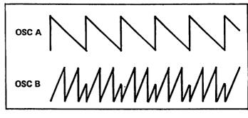
FIGURE 2-3 SYNCHRONIZATION OF OSCILLATOR B TO OSCILLATOR A
